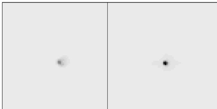
**Figura 5.16:** Comparación de la imagen obtenida por la cámara científica cuando el bucle está abierto (izquierda) y cerrado (derecha) con el simulador de turbulencia. Imagen obtenida con el filtro estrecho 1033/10. Las dos imágenes tienen el mismo nivel de brillo y contraste.
