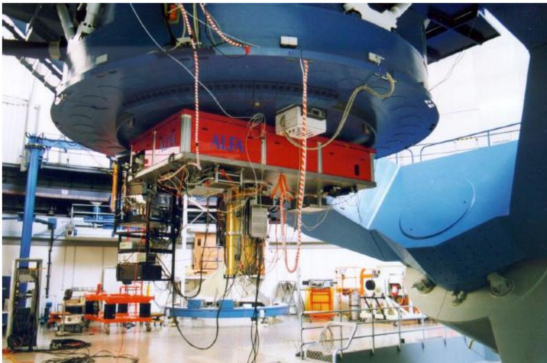
**Figura 3.13:** El sistema de óptica adaptativa ALFA+Omega Cass, situado en el foco Cassegrain del telescopio 3.5m del observatorio de Calar Alto.
