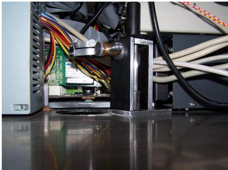
**Figura 4.9:** Detalle de la lente motorizada de enfoque para la cámara científica. Esta plataforma está ubicada en el nivel inferior de SAOLIM allí donde está alojada la electrónica.
