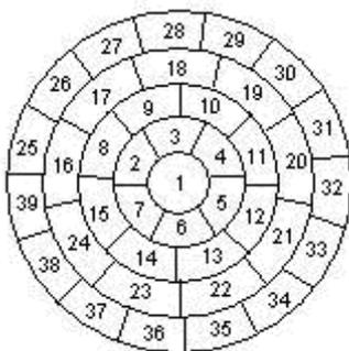
**Figura 10:** Distribución de actuadores en el espejo deformable.
