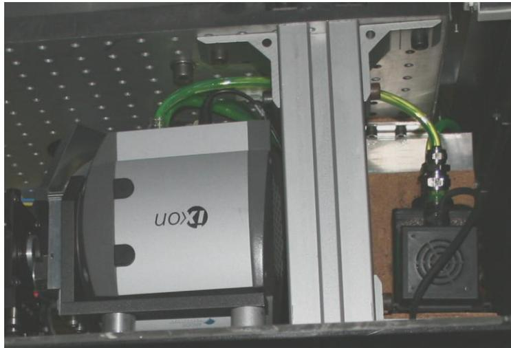
**Figura 4.39:** Detalle de la cámara IXON con el sistema de refrigeración líquida Bigwater 735 CL-W0075 de Thermaltake.
